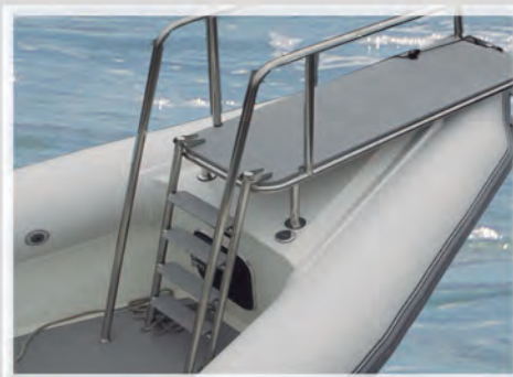
PLATAFORMA DE PROA C/ESCALERA INTERIOR
