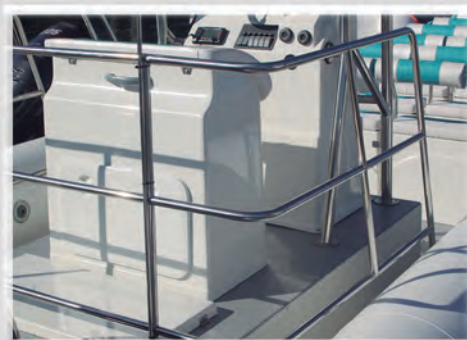
PLATAFORMA ELEVADA EN POPA
